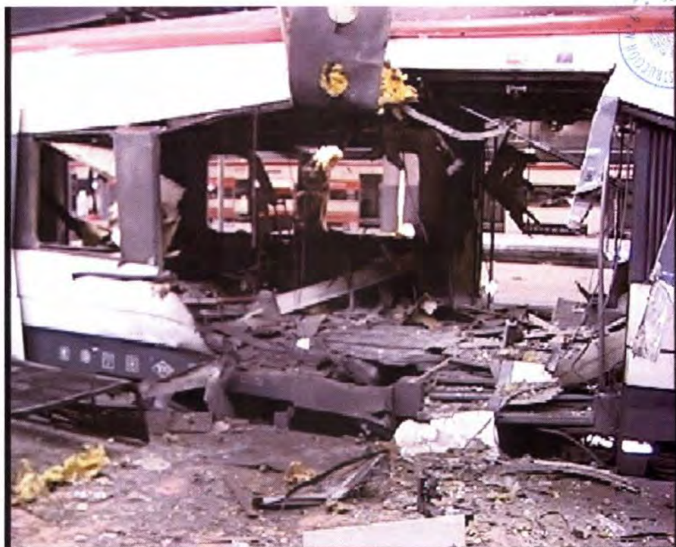
VISTA DE LOS EFECTOS DE LA EXPLOSIÓN EN EL COSTADO DERECHO DEL VAGÓN
