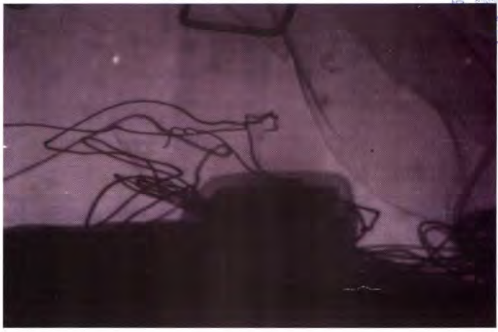
VISTA DE LA RADIOGRAFIA REALIZADA AL ARTEFACTO ANTES DE SU DESACTIVACIÓN
