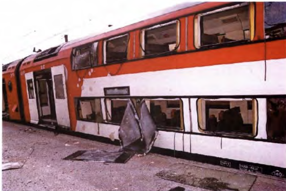
VISTA DE LOS EFECTOS DE LA EXPLOSIÓN EN EL VAGÓN Nº 3
