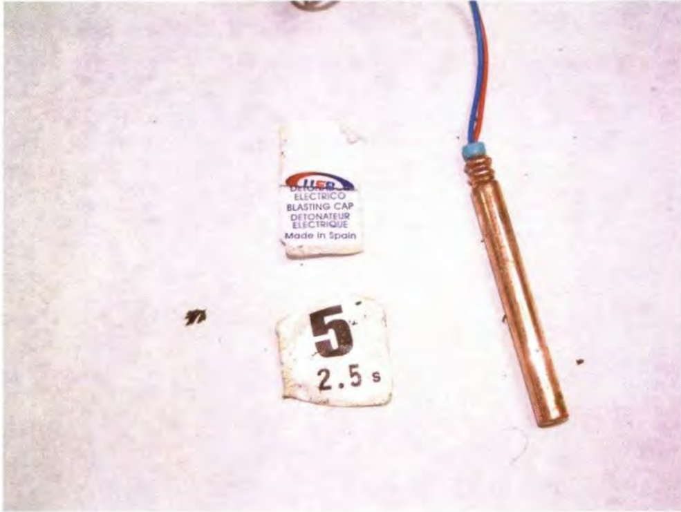
VISTA DEL DETONADOR ELÉCTRICO Y LAS ETIQUETAS QUE LLEVABA EN SU CABLEADO
